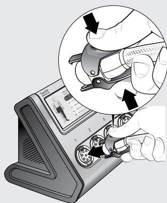
Figura 4.2.d. Conector de la manguera correspondiente con el conector de la unidad del controlador
