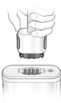
4. Empuje el conector hacia adelante; se enganchará a ambos lados del puerto de la unidad del controlador. Debería escuchar un clic cuando cada uno de los seguros se conecte correctamente. Se oirán dos clics, uno para cada botón (**Figura 3.4.b.**).
