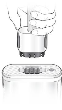
4. Empuje el conector hacia delante; se enganchará a ambos lados del puerto de la unidad del controlador. Debería escuchar un clic cuando cada uno de los seguros se conecte correctamente. Se escucharán dos clics, uno para cada botón (**Figura 3.3.b.**).
