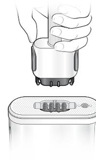
4. Empuje el conector hacia delante; se enganchará a ambos lados del puerto de la unidad del controlador. Debería escuchar un clic cuando cada una de las trabas se conecte correctamente. Se escucharán dos clics, uno para cada botón (**Figura 3.3.b.**).
