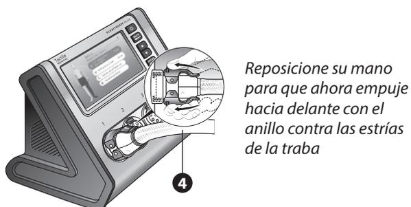
**Figura 4.3.d. Cómo manipular el conector de la manguera correctamente**
