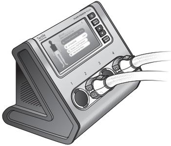
**Figura 4.3.h. Manguera totalmente conectada**
