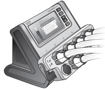
**Figura 4.3.i. Manguera totalmente conectada**
